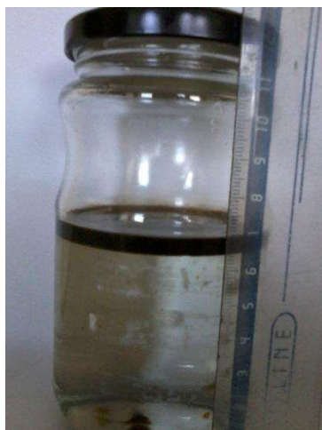
47 pav. Laisvų naftos produktų plėvelės storis (0,5 cm) paviršinėse lietaus nuotekose prieš valymo įrenginius 2017-09-19 d.
